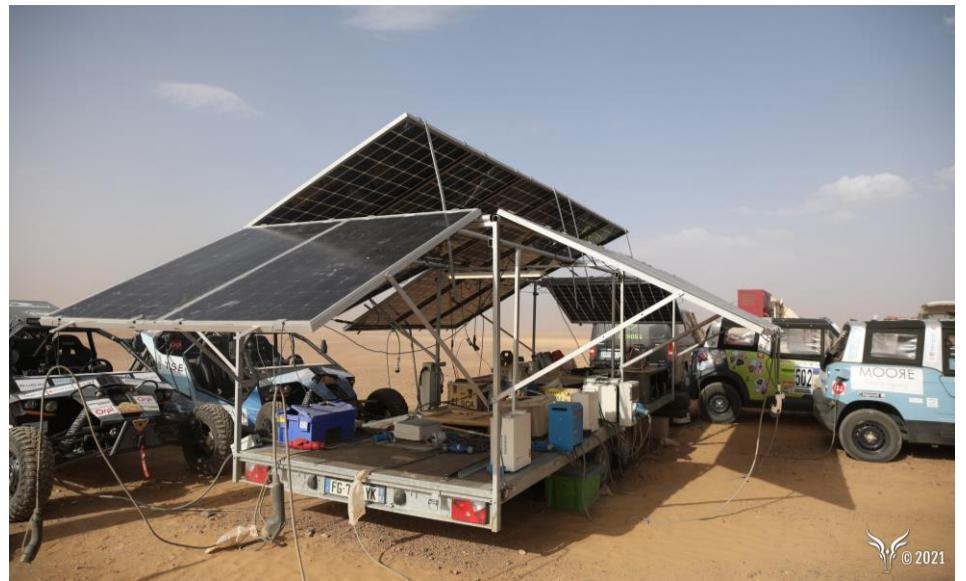
Cette année, 3 véhicules ont pu être chargés en totale autonomie grâce à 22 panneaux photovoltaïques orientables et inclinables de 375 watts chacun pour une superficie totale déployée de 36m<sup>2</sup>, le tout sur une remorque.
